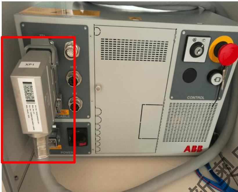
1.将动力电缆标注为**XP1**的插头接入控制柜**XS1**的插头上。
