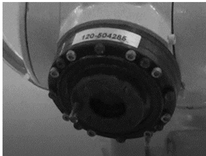
1. 安装工具快换装置的主端口，将定位销（工业机器人附带配件）安装在**IRB 120**工业机器人法兰盘中对应的销孔中，安装时切勿倾斜、重击，必要时可使用橡胶锤敲击。
