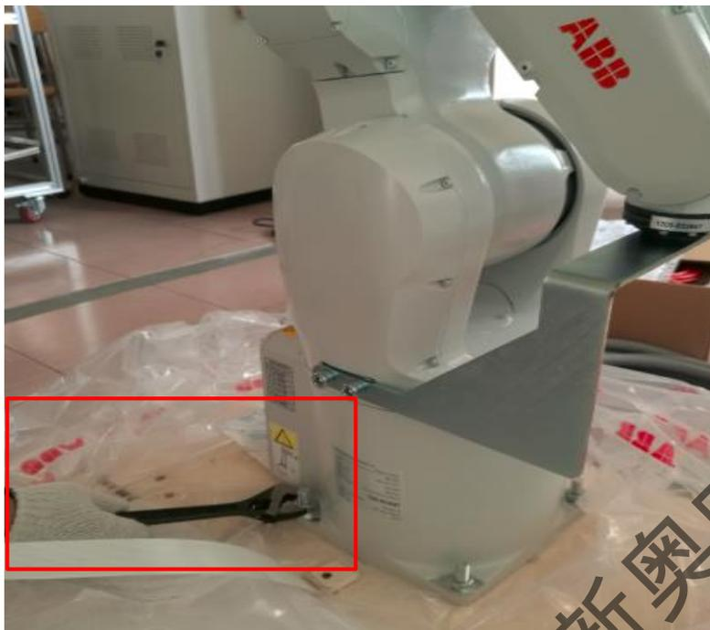
5.使用活动扳手卸下固定在底座上的4个螺丝和螺母。
