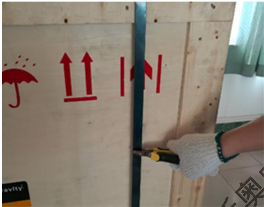
1. 带好纯棉手套，使用小剪钳工具剪断箱子上的两条钢扎带并取走。
