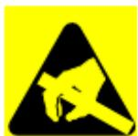
静电放电 (ESD)：针对可能会导致严重产品损坏的电气危险的警告。
