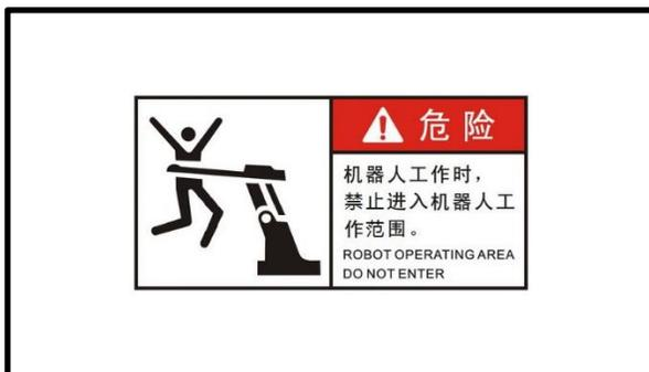
危险提示：机器人工作时，禁止进入机器人工作范围。
