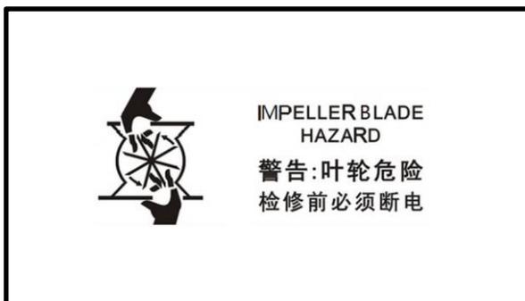
叶轮危险提示：叶轮危险，检修前必须断电。
