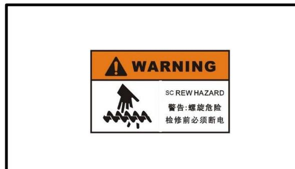
螺旋危险提示：螺旋危险，检修前必须断电。
