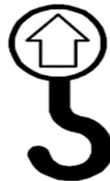
工业机器人提升：该标签用于对工业机器人的提升和搬运提示。
